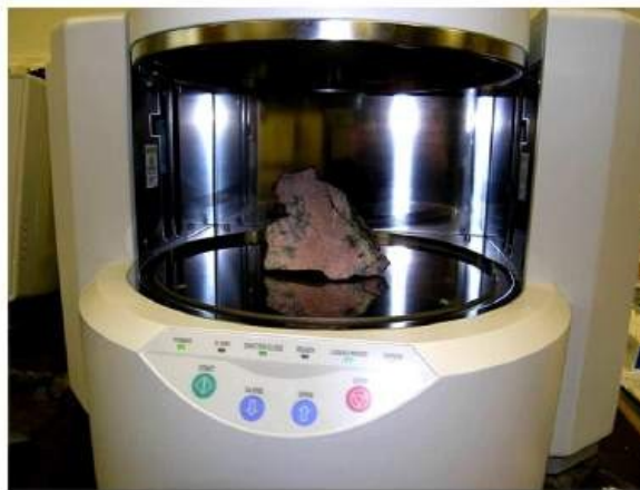
Камера спектрометра EDX-900HS с образцом
